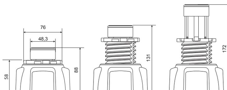
Matière : tampon en SBS\*, support-tampon, écrou rallonge, vis et embase en PP
