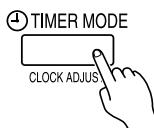
Appuyez sur le bouton “ TIMER MODE / CLOCK ADJUST” pour démarer le mode de la minuterie.
