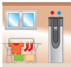
**INSTALLATION DANS UNE PIÈCE HORS GEL, VOLUME ≥ 20 m<sup>3</sup> (HORS ENCOMBRANTS), HAUTEUR SOUS PLAFOND ≥ 2,10 m**
