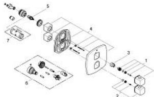
2: Poignée contrôle de température Grohtherm 1000 Performance (N ° de commande 47934000)
