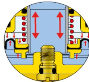
b) Le dispositif (B) contrôle le débit  $Q$ , en modifiant sa section de passage. La variation de la section détermine la valeur de la caractéristique hydraulique ( $k_v$ ) du dispositif de contrôle (B), qui reste constant sur :
