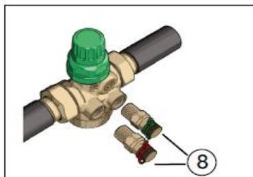
Pendant le fonctionnement, il est possible de mesurer la  $\Delta p$  de la vanne généré par le passage du fluide (avec l'appareil de mesure de différentiel de pression) (9). En comparant cette valeur avec la plage de  $\Delta p$  de fonctionnement, il est possible de déterminer si le débit réel de la vanne correspond au débit programmé.
