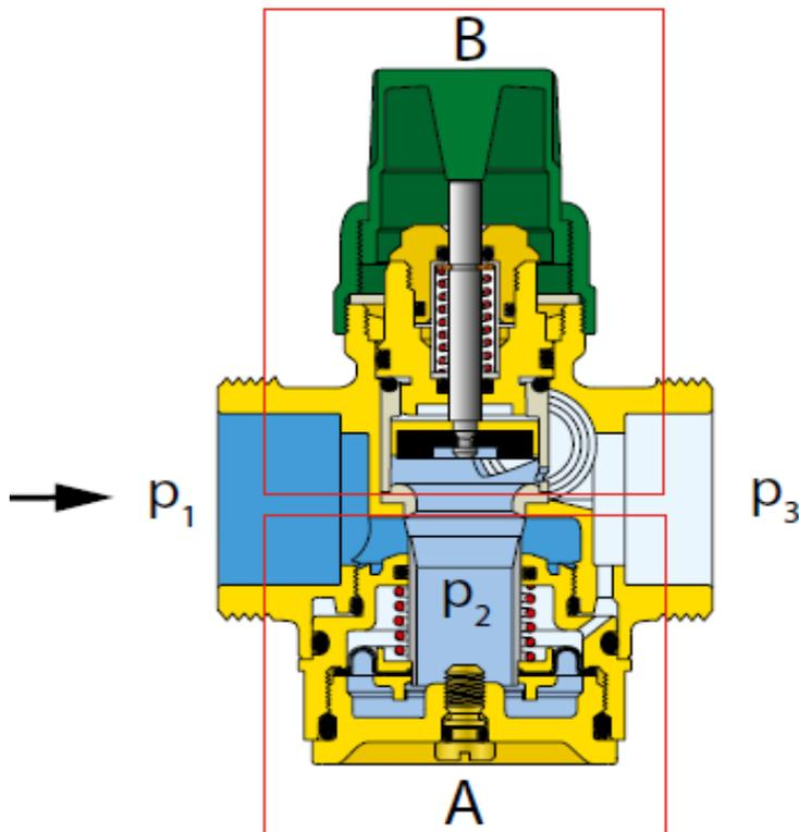
a) Le dispositif (A) contrôle et maintient constant le  $\Delta p_i$  ( $p_2-p_3$ ), aux bornes du dispositif (B), avec une action automatique (équilibre entre la force générée par le différentiel de pression et le ressort de rappel interne). Si  $(p_1-p_3) = \text{constant}$  ; dans ces conditions, le débit reste constant.
