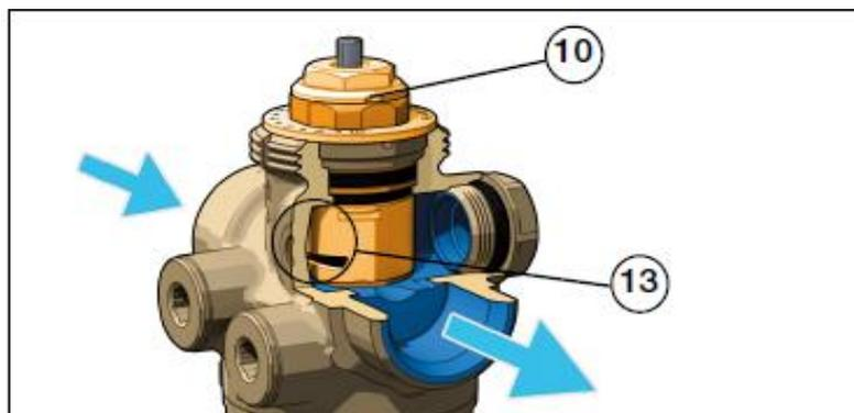
La rotation de la bague (10) détermine le numéro correspondant à la position de réglage et provoque l'ouverture / fermeture de la section de passage de l'oturateur externe (13). Par conséquent, chaque section de passage réglée sur la bague correspond à une valeur donnée de  $Q_{max}$ .
