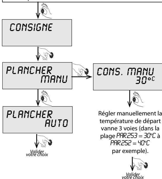
Régler manuellement la température de départ vanne 3 voies (dans la plage  $PAR.253 = 30^{\circ}\text{C}$  à  $PAR.252 = 40^{\circ}\text{C}$  par exemple).
