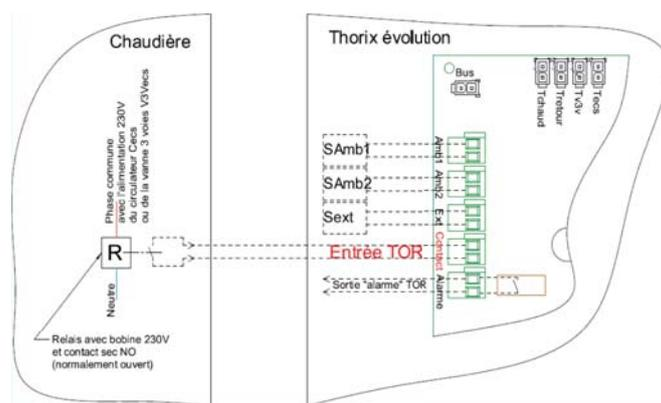
Ce raccordement est facultatif dans le cas où le générateur est équipé d'une vanne 3 voies directionnelle qui assure le basculement total en fonction sanitaire lors de la demande.
