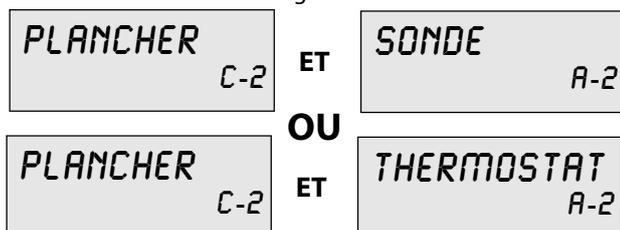
**3.4.7 - Alimentation chaudière devant être contrôlée par l'aquastat de sécurité à 65°C dans le cas d'une application plancher chauffant en circuit n°2**
