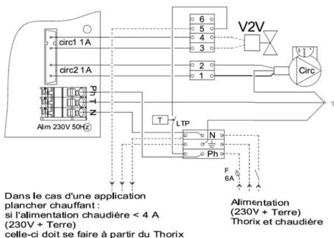
**3.4.7.2 - Chaudière avec alimentation ≥ 4A ou pompe à chaleur haute température (≥65°C) ou pompe à chaleur avec appoint chaudière ou électrique**
