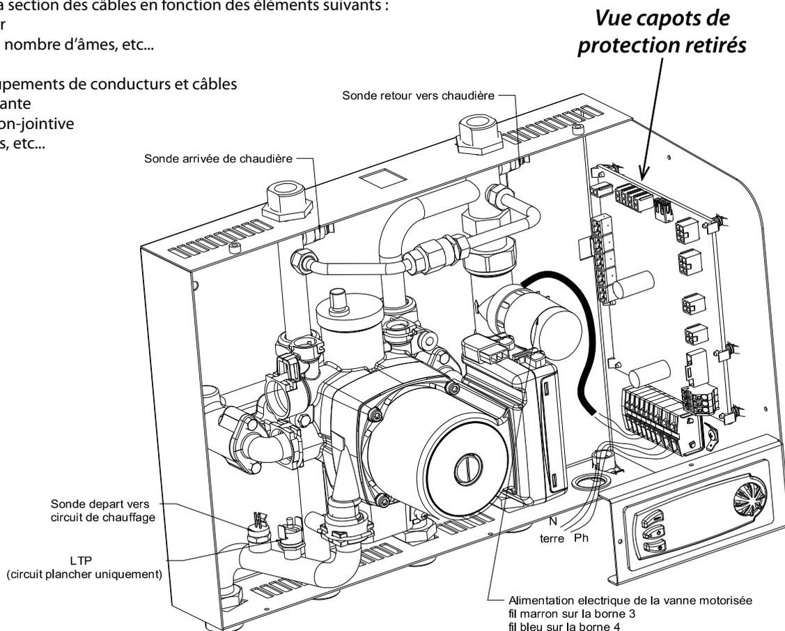
Les bornes de raccordement sont des bornes à ressort «CAGE CLAMP», pour la manipulation utiliser un tournevis à lame 3,5 x 0,5mm
