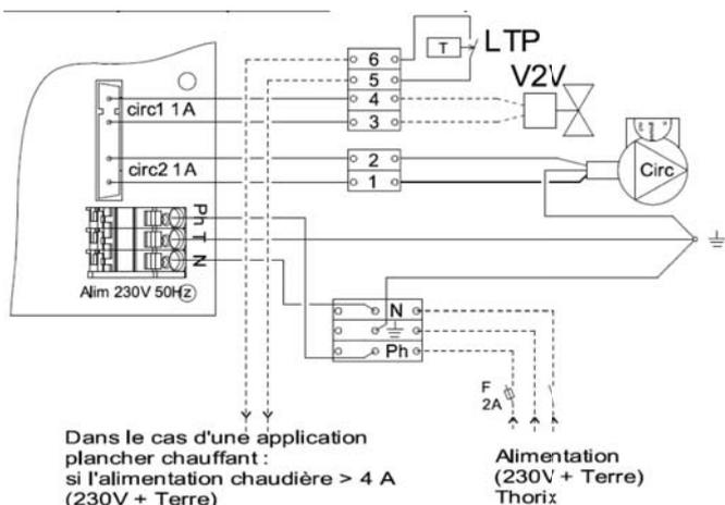
Dans le cas d'une application plancher chauffant : si l'alimentation chaudière > 4 A (230V + Terre) l'aquastat de sécurité plancher (LTP) doit être raccordé sur l'entrée délestage total de la chaudière et provoquer son arrêt.
