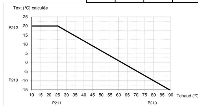
La température de consigne départ vanne 3 voies se déduit de la température lue par la sonde «Tchaud» :
