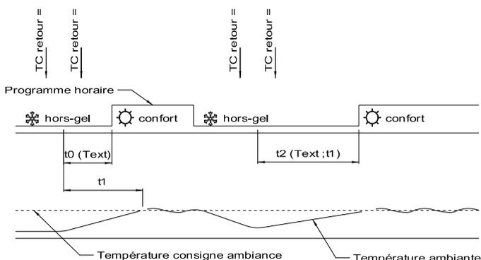
La durée d'anticipation initiale =  $t_0 = 4$  heures en plancher chauffant et 45 minutes en radiateurs modulée en fonction de la température extérieure (Text).
