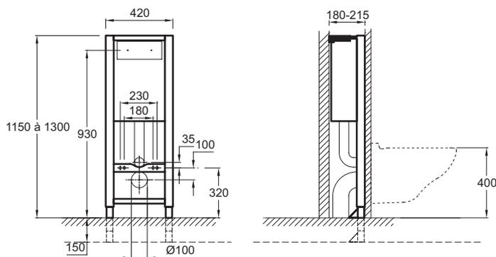
Descriptif CCTP : Bâti-support au sol avec réservoir à mécanisme 3/6 L. E4311. Collection : HORS COLLECTION. Dimensions : 42 x 0 cm. Poids : 17 kg. Type d'installation : Autoportant ou en applique sur mur ou en cloison légère ou en gaine technique. Consommation d'eau : Standard 3/6 L. Livré avec jeu de fixations murales. Livré avec 2 tiges filetées M12 pour fixation de la cuvette avec protection. Plaque de commande non incluse.
