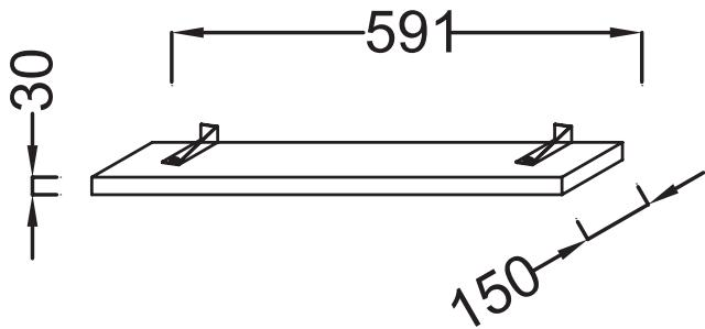
Descriptif CCTP : Bandeau lumineux 59,1 cm. EB1216. Collection : STRUKTURA. Dimensions : 59,10 x 15 x 3 cm. Poids : 2 kg. Matériau : Mélaminé. Type d'installation : Mural. Électricité : 12V, 20W (par spot), classe II IP44. Sans prise de courant ni interrupteur sur le bandeau.
