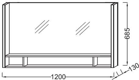
Descriptif CCTP : Miroir 120 cm. EB1183. Collection : TERRACE. Dimensions : 120 x 13 x 68,50 cm. Poids : 21 kg. Type d'installation : Suspendu. Rangement : Etagère bois massif. Électricité : 230V, 14,4W, classe II IP44.
