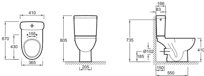
Descriptif CCTP : Pack WC sortie horizontale. E0521. Collection : ODÉON UP. Dimensions : 67 x 41 cm. Poids : 38,4 kg. Matériau : Céramique. Type d'installation : Au sol. Normes et réglementations : NF. Consommation d'eau : Standard 3/6 L. Hauteur : Confort. Type de bride : Ouverte (traditionnelle). LIVRÉ AVEC : Abattant thermodor à descente progressive et déclinable, charnières métal 8409K ; kit de fixation rapide au sol. Alimentation latérale.
