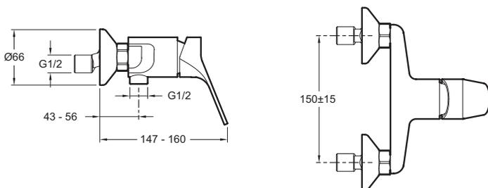
Description : Mitigeur douche mural. E75765. Collection : BRIVE. Poids : 1,1 kg. Type d'installation : Mural. Normes et réglementations : NF : IA - ECAU : E1 C2 A2 U3 (Ge3) - ACS : 15 ACC LY 472. Débit (l/mn sous 3 bars) : 12. Raccords : Avec raccords et rosaces murales. Mécanisme : Cartouche à disques céramique. Entraxe (mm) : 150 ± 15 mm. Clapet anti-retour sur la sortie douche..
