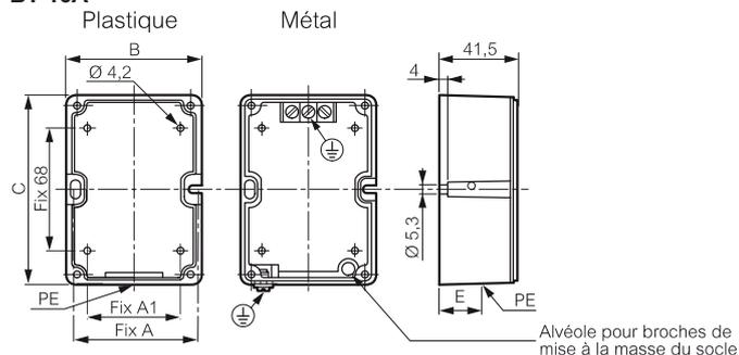
Fix A1 et Fix 68 : points de fixation intérieurs facultatifs operculables
