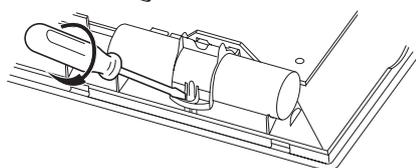
**Remplacer par une nouvelle batterie (revisser le collier)**
