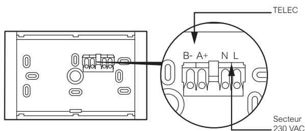
Raccorder les 2 fils de télécommande sur les bornes B- et A+ et les 2 fils d'alimentation sur les bornes N et L.
