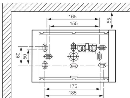
Fixer le bloc en utilisant 2 points de fixation (pré-perçés).
