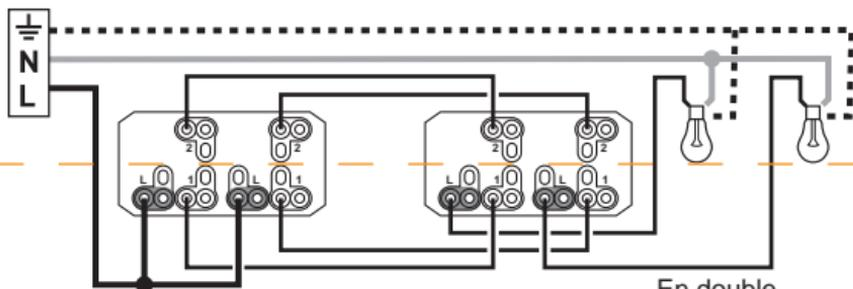
En double va-et-vient, commande de 2 endroits différents
