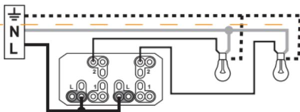
En double interrupteur, commande d'1 seul endroit
