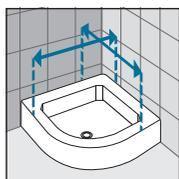
Prendre les mesures du mur au bord extérieur du receveur de douche. Relever les mesures après la pose du carrelage. Pour les montages en angle, il faut prévoir que la mesure réelle correspond à la mesure d'encombrement extérieur avec le profilé mural de la paroi en retour. Ceci doit être pris en compte impérativement pour les receveurs carrelés (pose à l'italienne ou receveur sans plage).
