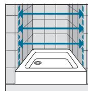
Prendre les mesures d'un mur à l'autre, en bas, en haut et au milieu et choisir la mesure inférieure. Relever les mesures après la pose du carrelage.
