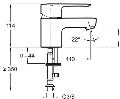
Description : Mitigeur lavabo, corps lisse, sans tirette, sans vidage.. E16027-4ND. Collection : JULY. Poids : 1,2 kg. Normes et réglementations : NF : I - ECAU : E0 C2 A2 U3 - Ge3. Débit : 10 l/mn sous 3 bars. Mécanisme : Cartouche à disques céramique.
