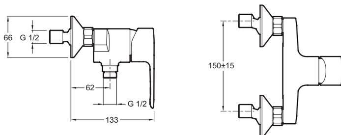
Description : Mitigeur douche mural.. E16029-4. Collection : JULY. Poids : 1,4 kg. Normes et réglementations : NF : IA - ECAU : E1 C2 A3 U3 - Ge3, ACS n° 10 ACC LY 113. Débit : 14 l/mn sous 3 bars. Mécanisme : Cartouche à disques céramique avec de débit. Entraxe : 150 ± 15 mm.
