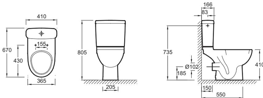
Description : Pack WC sortie horizontale basse consommation NF 6 L. E0520MA. Collection : ODÉON UP. Dimensions : 67 x 36,5 cm. Poids : 38,4 kg. Matériau : Céramique. Type d'installation : Au sol. Volume d'eau : Economie d'eau 2,6/4 L. Hauteur : Confort. Type de bride : Ouverte (traditionnelle). LIVRÉ AVEC : Abattant thermodur, charnières métal 8407K ; kit de fixation rapide au sol. Alimentation latérale.
