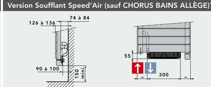
\* Attention ! Les entraxes et systèmes de fixations sur les modèles Speed'Air ne sont pas les mêmes que sur les modèles standard (cf notice).
