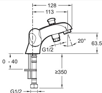
Description : Mélangeur bain-douche monotrou. E71921. Collection : GALÉO CD. Poids : 1,6 kg. Normes et réglementations : NF : IC/A - ECAU : E4/1 A2 U3 - ACS : 10ACCLY238. Débit : 14 l/min (douche) et 25 l/min (bain) sous 3 bars. Saillie du bec : 113 mm. Raccords : Avec flexibles d'alimentation. Mécanisme : Têtes à disques céramique. Poignées métal. Inverseur automatique. Clapet anti-retour sur la sortie douche.
