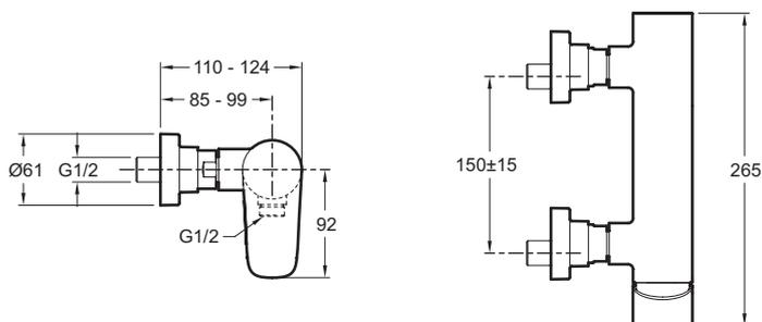
Descriptif CCTP : Mitigeur douche mural.. E72351. Collection : ALEO. Poids : 1,9 kg. Type d'installation : Mural. Normes et réglementations : NF : IA - ECAU : E1 C2 A3 U3 (Ge3) - ACS : 10 ACCLY 113. Débit (l/mn sous 3 bars) : 14 l/mn. Raccords : Avec raccords et rosaces murales. Mécanisme : Cartouche à disques céramique. Entraxe (mm) : 150 ± 15.
