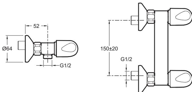
Description : Mélangeur douche. E71923. Collection : GALÉO CD. Poids : 1,1 kg. Type d'installation : Mural. Normes et réglementations : NF : IA - EAU : E1 A1 U3 - ACS : 15ACCLY264. Débit : 14 l/mn sous 3 bars. Raccords : Avec raccords et rosaces murales. Mécanisme : Têtes à disques céramique. Entraxe :  $150 \pm 20$  mm. Clapet anti-retour sur sortie de douche.
