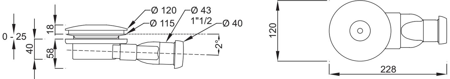
Description : bonde. E78168. Collection : HORS COLLECTION. Poids : 0,3 kg. Diamètre de bonde : 90. Débit 36L/ min. Encombrement réduit 58mm.
