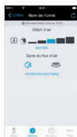
Réglage de la vitesse de ventilation et du sens du flux d'air
