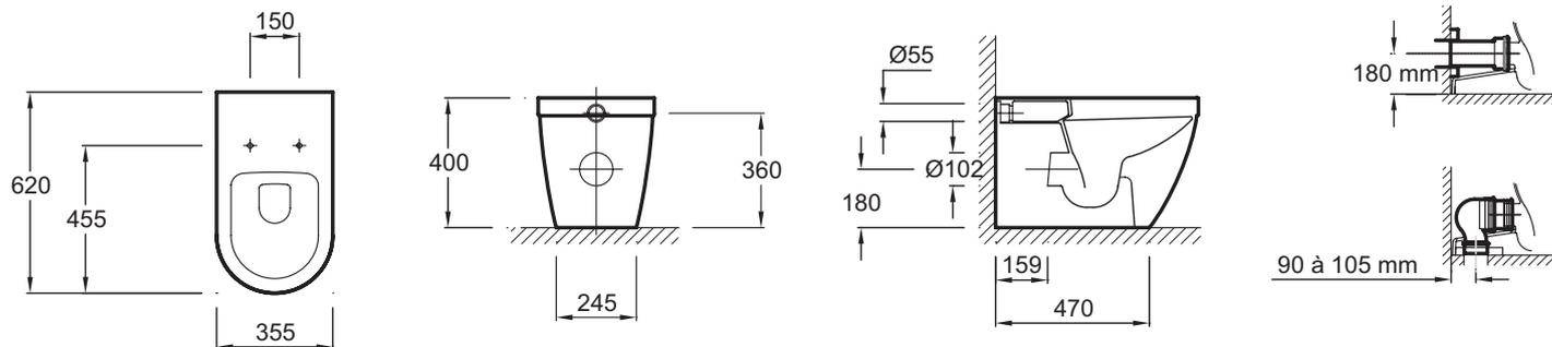
Descriptif CCTP : Cuvette indépendante vario carénée jusqu'au mur. EDD102. Collection : RODIN. Dimensions : 62 x 35,50 cm. Poids : 33 kg. Matériau : Céramique. Type d'installation : Au sol. Consommation d'eau : Standard 3/6 L. Hauteur : Confort. Type de bride : Fermée. Fonctionnement 3/6 L.
